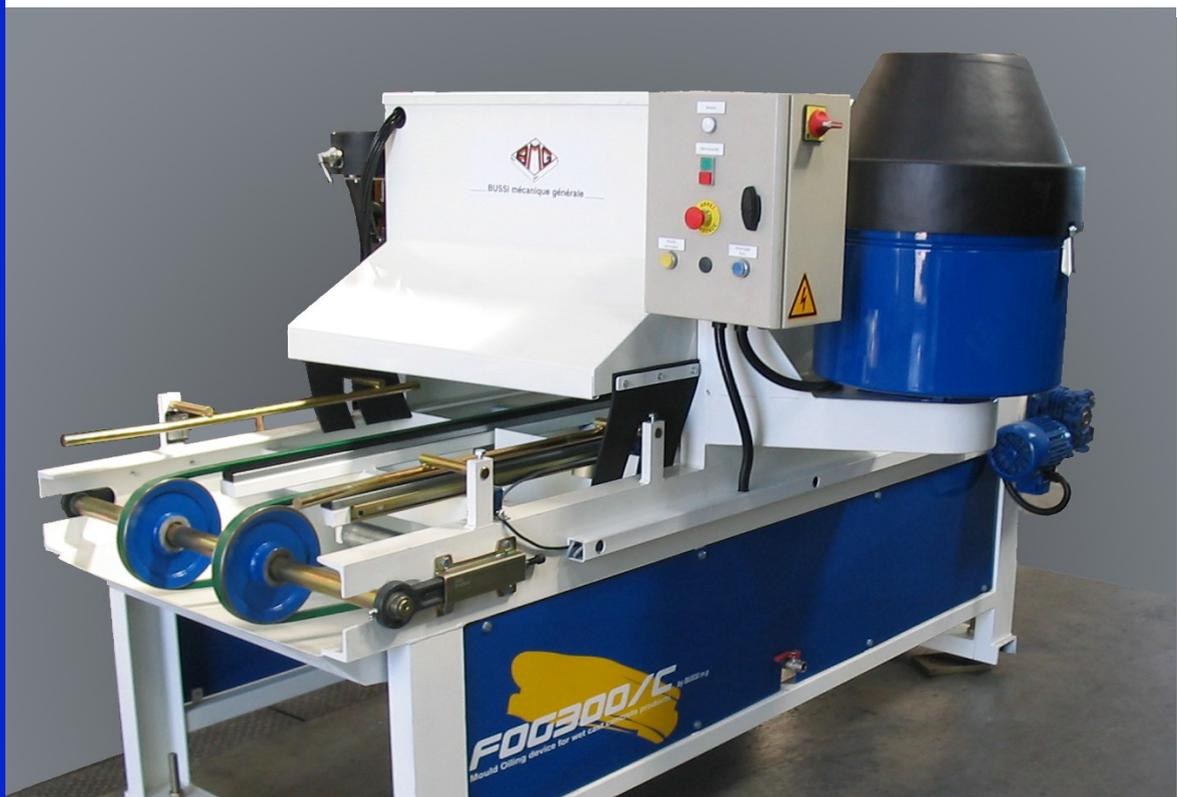
**FOG 300/C** est un dispositif conçu spécifiquement pour la pulvérisation automatique d'agent démoulant sur des moules de types divers, destinés à contenir du béton. Ceci dans le respect de la législation puisqu'un filtre assure le traitement des brouillards qui ainsi, ne sont pas rejetés dans l'air ambiant.
